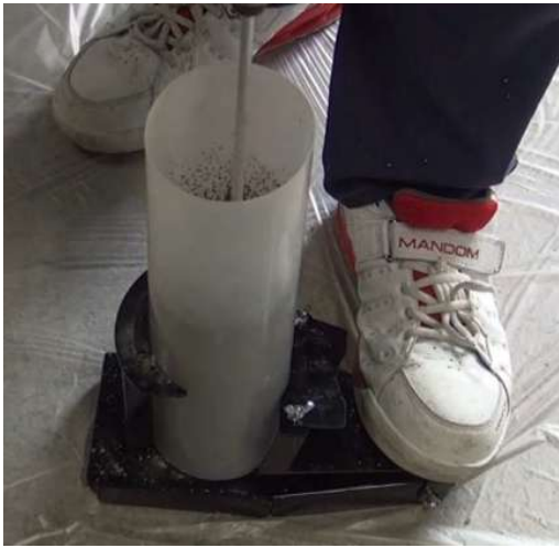
① 踏板を踏込み容器を固定後、攪拌する
