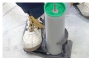
3 カートリッジを設置し台を踏み固定して攪拌
