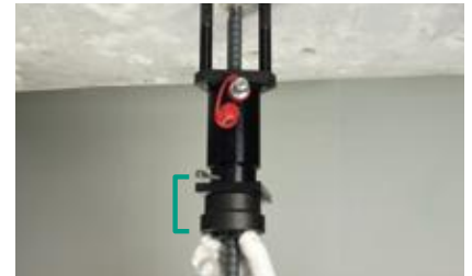
3 異形鉄筋用チャックをセット ※異形鉄筋用チャックは別売りです。
