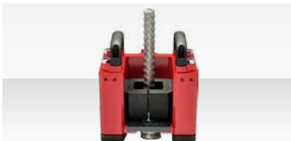
2 専用異形鉄筋チャックを設置
