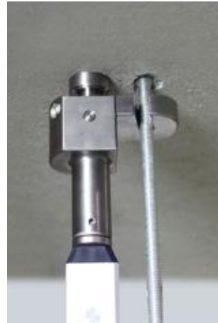
吊天井ボルト専用検査治具
