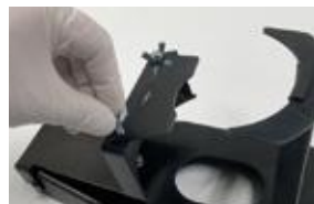
1 カートリッジに合わせて固定プレートを装着
