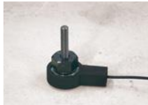
2 センターホール型荷重計を 設置
