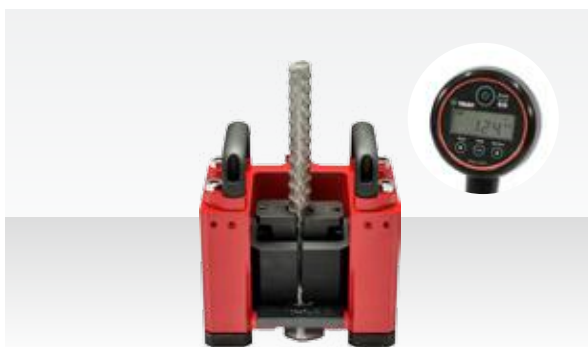
3 油圧ポンプにて加圧
