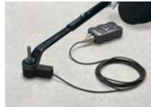
3 スパナなどで専用カプラを 締めながら測定
