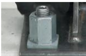
4 止めねじをセットし、ヘキサゴンヘッドのトルクレンチで規定値まで締め込んで完了。(合いマークをつけることをおすすめします。)
