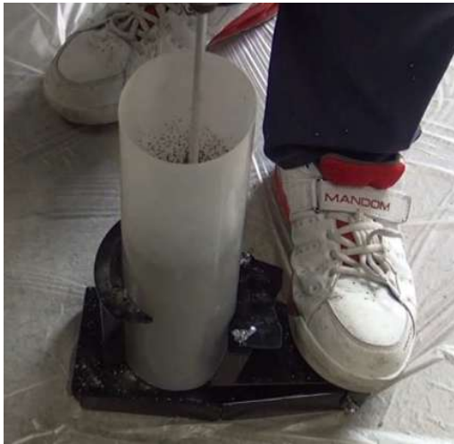
① 攪拌台を踏み込み容器を固定し、攪拌する
