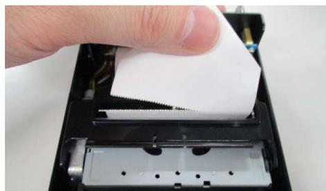
⑥記録紙用フタの切り欠きをケースの内側に入れた後、記録紙用フタを閉じるようにして内側のマグネットで固定します。
