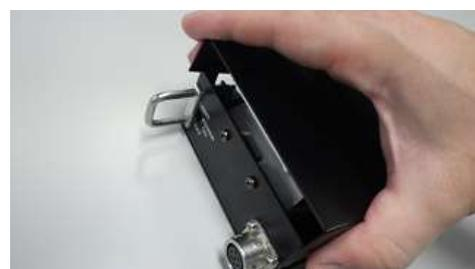
②ロックレバーを下に押し下げて解除し，ペーパーカバーを上の方に開きます。
