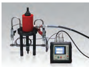
非破壊荷重-変位試験
