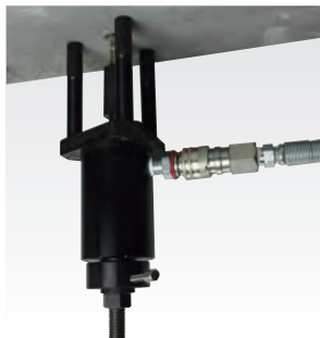
仮固定治具により上向き(天井向き)試験時、作業効率アップ
