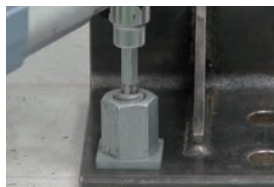
④止めねじをセットし、ヘキサゴンヘッドのトルクレンチで規定値まで締め込んで完了。(合いマークをつけることをおすすめします。)
