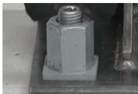
④止めねじをセットし、ヘキサゴンヘッドのトルクレンチで規定値まで締め込んで完了。(合いマークをつけることをおすすめします。)
