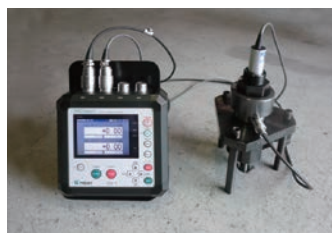
レンチ式試験装置+変位変換器との組合せ
