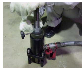
④ ワッシャー・ナットを取付けます。
