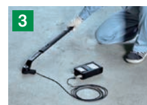
専用スパナを用いて専用カブラを締めながら測定
