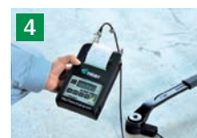
デジタル表示器付プリンターで測定データを確認。その場でプリントアウト
